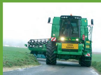
1 panneau CONVOI AGRICOLE à l'avant et à l'arrière du convoi
