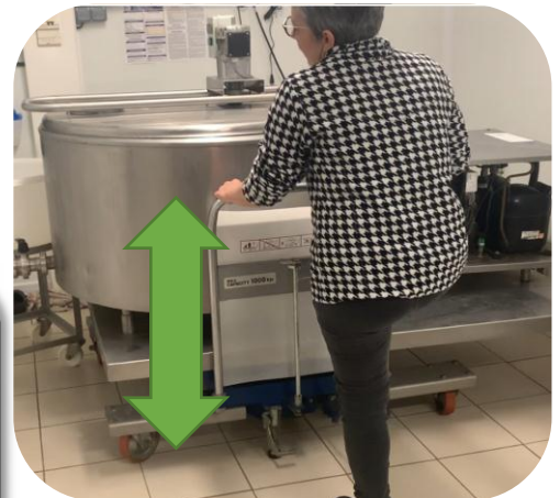
Accéder au tank avec une table élévatrice
