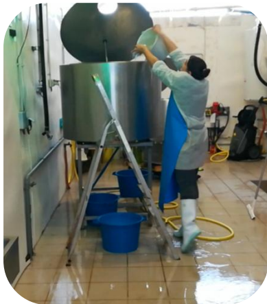
Accéder au tank avec un escabeau
